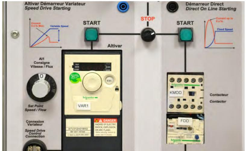
L'appui sur le bouton poussoir vert « START » provoque le démarrage direct du moto-ventilateur à sa vitesse nominale.
