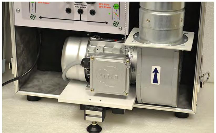
Le flux d'air peut être modulé par simple action d'un diaphragme en sortie.
