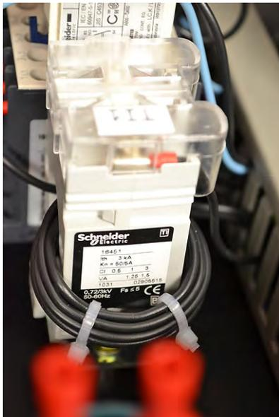
La mesure du courant est effectuée grâce à un Transformateur de Courant (TC) câblé à l'intérieur de la valise.
