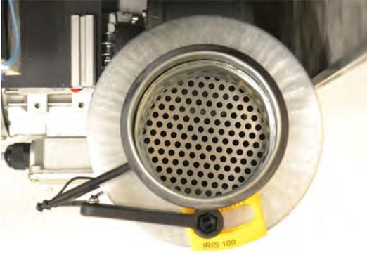
La sortie du diaphragme est équipée d'une grille de protection évitant les blessures ou l'entrée d'objets dans celui-ci.
