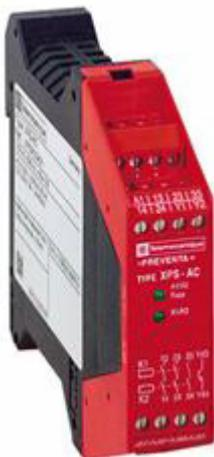
La tension d'alimentation est appliquée, à travers les contacts à ouverture du (ou des) bouton(s) AU, à A1/A2. Les contacts à ouverture des relais, intercalés à la suite des sorties doivent être insérés dans la boucle de retour entre Y1/Y2, en série avec les conditions de démarrage. Par cette mesure le démarrage de l'appareil n'est possible que si les relais, liés à la sécurité, sont retombés au repos après avoir reçu une commande d'arrêt d'urgence.
