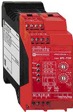
Les modules de sécurité XPS TSW s'utilisent dans les applications nécessitant des temporisations de sécurité, avec contact de passage de sécurité (contact de shuntage en association avec les modules XPS VN pour la surveillance de vitesse nulle, la surveillance d'électrovannes, .....).
