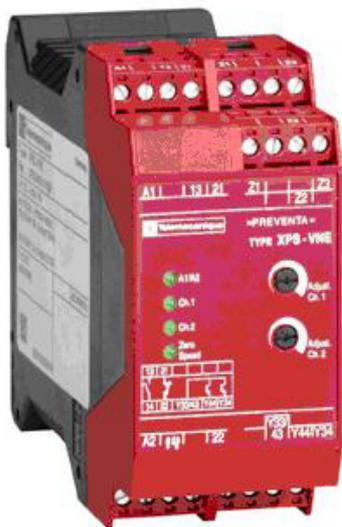
Le module XPS VNE est utilisé pour la détection d'arrêt des moteurs électriques. Il est employé essentiellement dans les commandes dotées d'un mécanisme d'inversion du sens de rotation du moteur ainsi que pour le déblocage du système de verrouillage des protecteurs mobiles.
