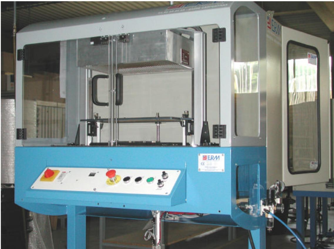
Les pièces mobiles du four sont entraînées par un vérin alimenté en air comprimé, une pompe à vide permettra de faire le vide entre la plaque de PVC et le moule
